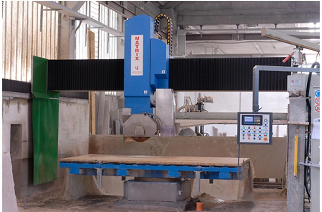
**CNC Brückenfräse, 5 Achsen Interpolar gesteuert.**
