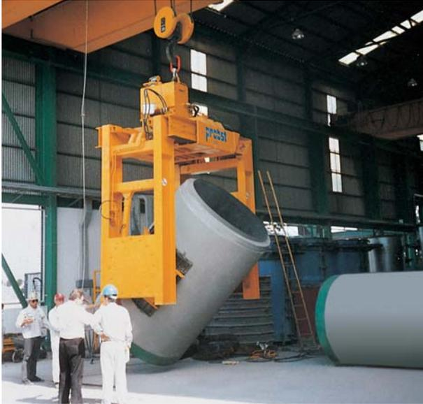
Portalkran-Wendegreifer PWG-R für Betonrohre
