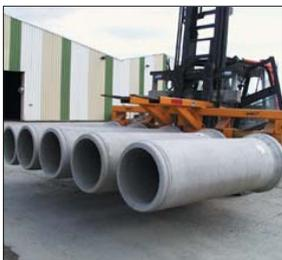
Mehrfachdorn MFD-UNI hydraulisch verstellbar
