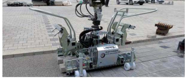
HVZ-GENIUS-II Hydraulische Verlegezange für den universellen Baggereinsatz
