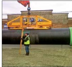
Vakuum-Traverse VT für Rohre
