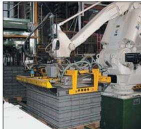
ROBOGRIP P-4 Pneumatischer Robotergreifer
