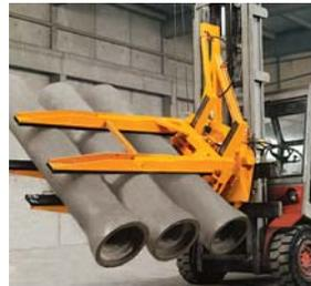
Wendegerät für Betonrohre WG-R
