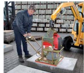
VM mit QUICKJET QJ-600-E Vakuum-Anbaugerät
