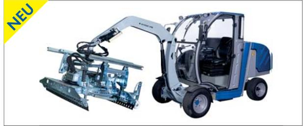
VM-X-PAVERMAX comfort Verlegemaschine mit HVZ-UNI-II
