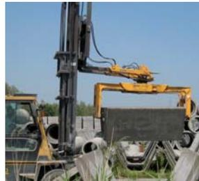
Stapler-Anbauzange STAZ für Betonfertigteile
