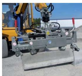
Hydraulische Versetzzange VZ-H-UNI
