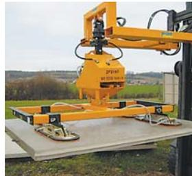
Vakuum-Hebegerät SH-1000-MINI mit Traverse
