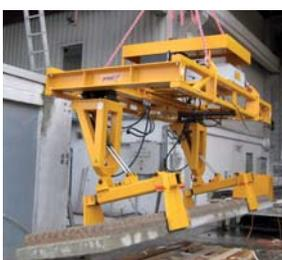
Aufstellgerät für Schallschutz-
