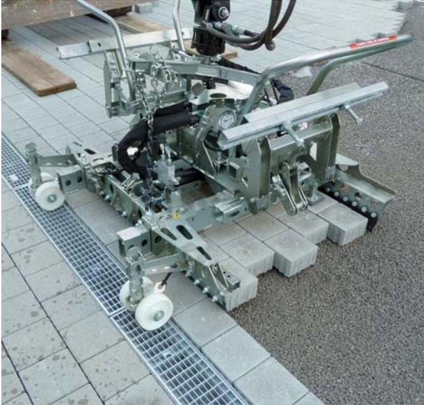
HVZ-ECO Hydraulische Verlegezange
