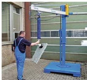
VACUSPEED VXS Vakuum-Schlauchheber
