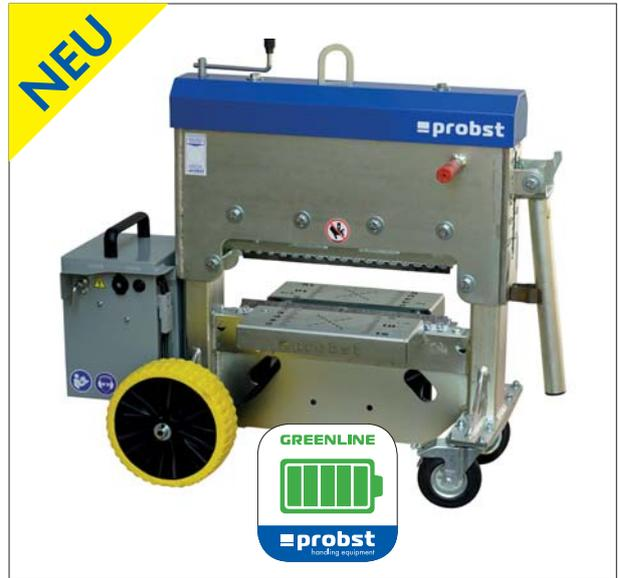
STONE SPLITTER STS-43-EH-23 Elektrohydraulischer Steinknacker
