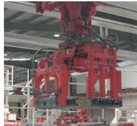
Hydraulische Abtragezange mit 180° Drehbacken
