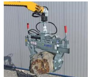
Hydraulische Versetzzange VZ-H-UNI
