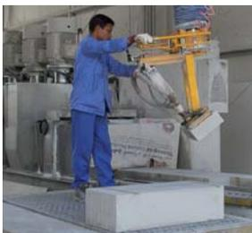
Pneumatisch schwenkbare Saugplatte ESP-SW-P Sonder
