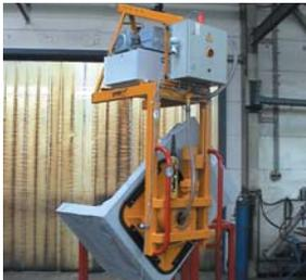
Vakuum-Hebegerät mit 180° Dreheinheit
