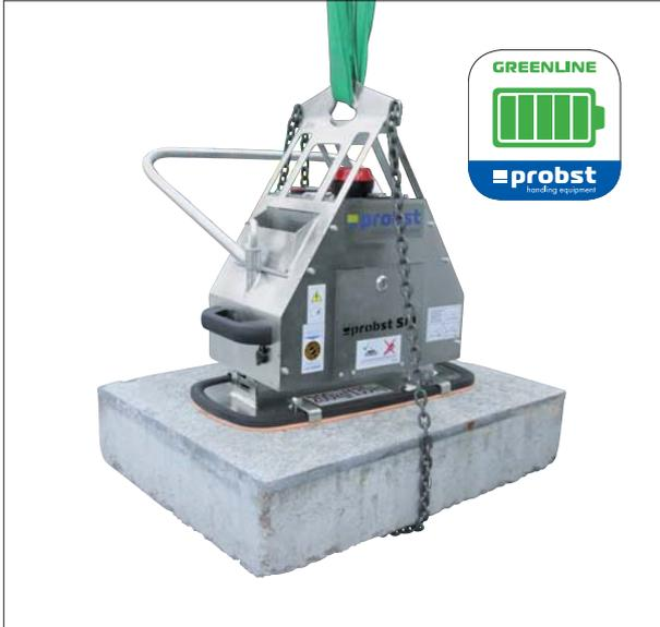
STEINMAGNET SM-600-GREENLINE-POWER Vakuumanbaugerät
