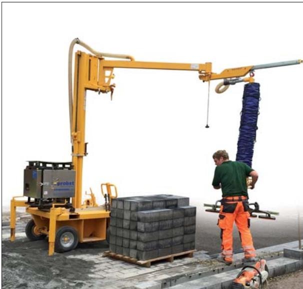
JUMBOMOBIL JM-VARIO Vakuum-Plattenverlegemaschine
