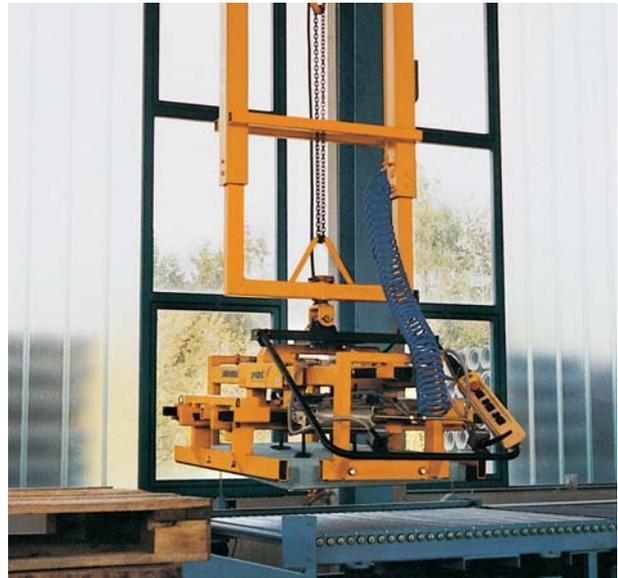
Pneumatische Abtragezange ATZ-P mit SRF
