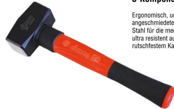
Ergonomisch, unzerstörbar, vibrationsfrei – daher gelenkschonend. Patentierter Kopf mit angeschmiedetem Stielschutzkragen aus hochwertigem Stahl mechanisch fixiert durch Keil aus Stahl für die mechanische Blockierung, Seele aus Aluminiumlegierung. Polyamid-Komponente ultra resistent auch gegen Öl und Lösungsmittel, Griff und Schutzhülse aus thermoplastischem rutschfestem Kautschuk.
