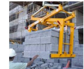
Mechanischer Scherengreifer SG
