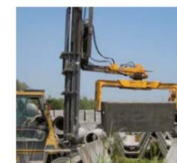
Stapler-Anbauzange STAZ für Betonfertigteile
