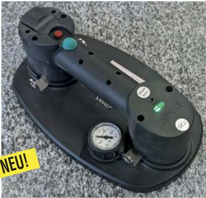
Der weltweit erste völlig elektrisch akkubetriebene Vakuum-Handsauger. Auch poröse und raue Oberflächen wie Holz, Rigips, Betonstein und Sandwich-Fassaden-Elemente lassen sich mit dem Grabo ansaugen und somit leicht heben. Der Grabo besitzt eine Hebekraft von bis zu 170 kg. Mit Vakuum-Anzeige.
